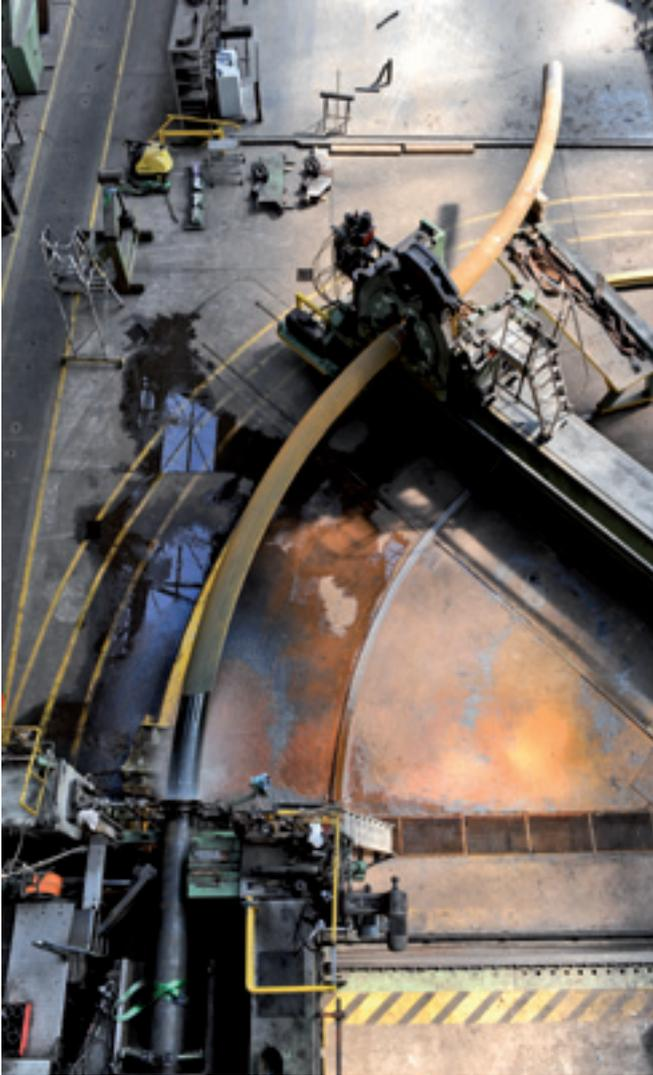
Für die Gründungsstrukturen wurden im Konzernverbund mit Salzgitter Mannesmann Grobblech speziell entwickelte S-Bögen gefertigt. Die HFI-geschweißten Rohre lieferte Salzgitter Mannesmann Line Pipe.
