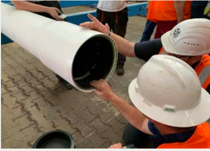
Das Zap-Lok™-Projektteam in Hamm begutachtet gemeinsam die ersten Ergebnisse der Drei-Lagen-Kunststoffumhüllung.
