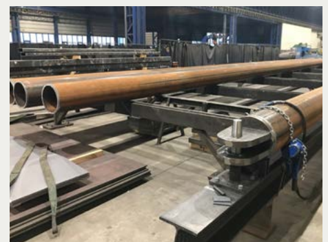
Oben: Bei der Stahl- und Anlagenbau Schädlich GmbH wurden die Rohre mit Gabelköpfen versehen und anschließend gestrahlt und lackiert.
