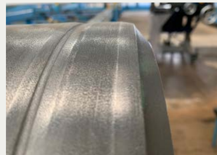
Die am Mannesmann Line Pipe Standort Hamm gefertigten Rohre wurden mit einer speziellen Nut und Fase versehen.
