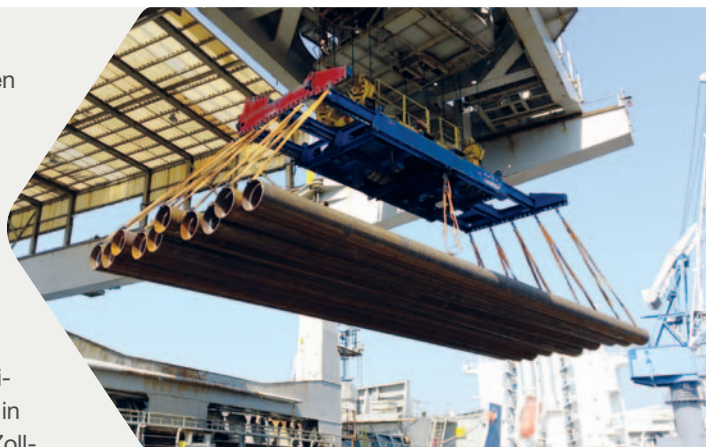
Im Hafen Bremen: Die Rohre werden streng nach Handling- und Stauvorschriften geladen. Foto: © ISB
